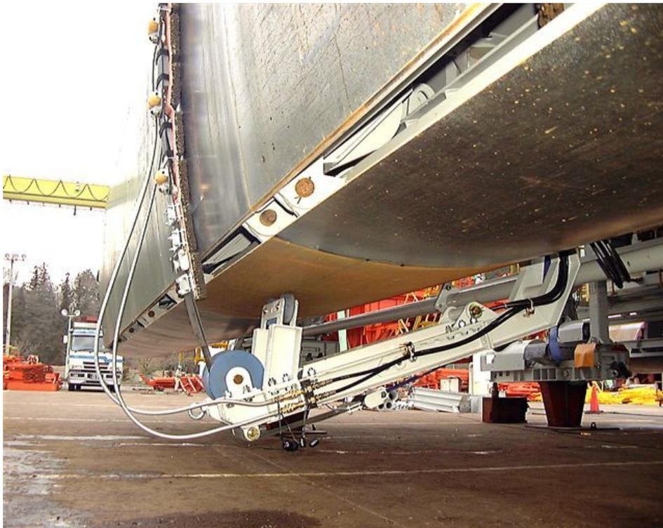
弊社ベストセラー製品の剥離剤塗布装置付きケレン装置です。ケレン作業を低減し省力化が可能です。
